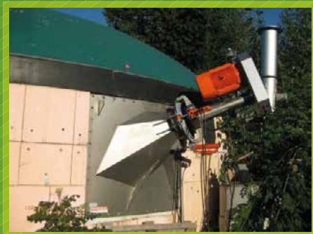
Multimix 1m20 de diamètre - bras long 6m50, idéal pour niveau variable et pré-fosse
