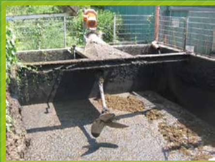
Multimix 1m20 de diamètre - bras long 6m50, idéal pour niveau variable et pré-fosse
