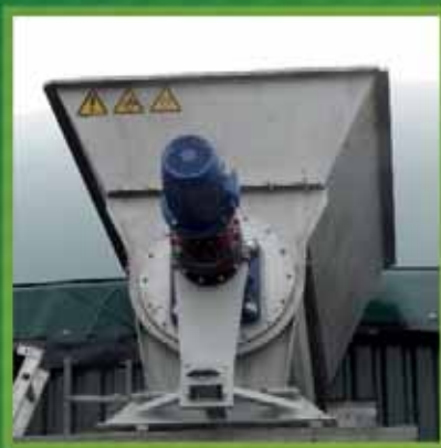
Trémies d'alimentation - INOX de 10 à 40 m 3 de capacité
