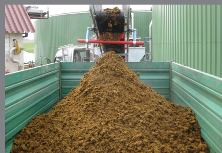
Envoi des solides directement sur la remorque
