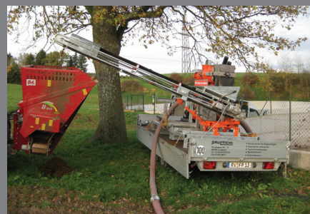
Séparation directement dans le distributeur de la litière
